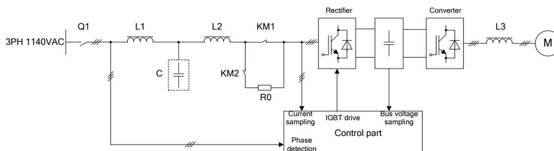
Figure 5.1 PWM rectifier
